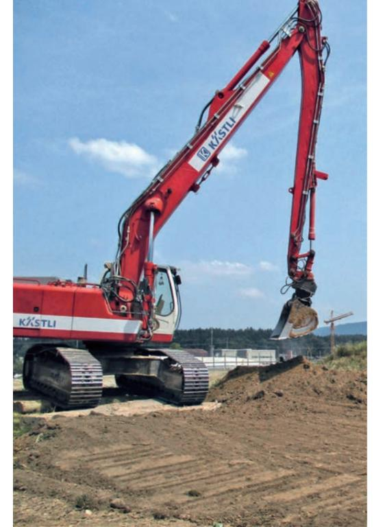
**Spezialgerät: Langer Ausleger für zum Beispiel schonendes grossflächiges Anlegen von Unterboden und Humus**
