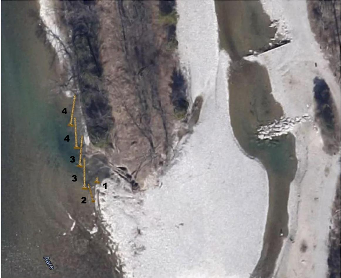
Skizze der realisierten Totholzelemente in der Aare Hunzigenau, Rubigen.
