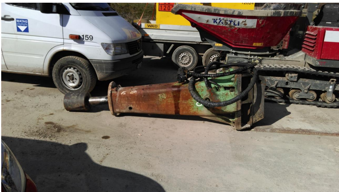
Foto des Rammhammers (Foto Kästli Bau AG)
